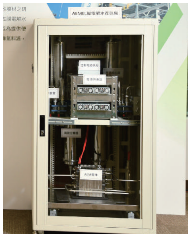
氫能潔淨，用途多元，但氫的取得方式是一大關鍵，主要來源之一便是透過電解水產氫技術。圖為再生能源電解產氫系統。
