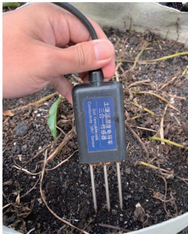
研發完善的「AgriTalk 智慧農業系統」，可運用感測器偵測土壤溫度、濕度、導電度、PH 值、大氣壓力等數值。
